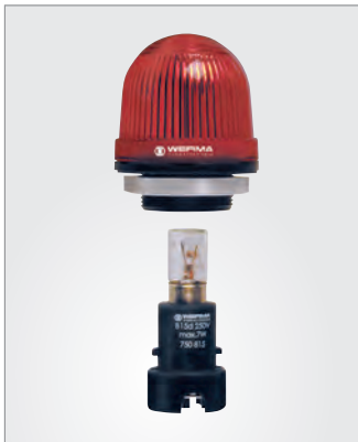
Lampenwechsel von hinten durch Bajonettverschluss
